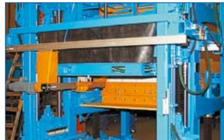
**Applicazione nell'industria meccanica:** macchina per la fabbricazione di mattoni profilati in cemento
