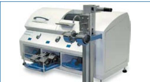
**Esempio di applicazione nell'industria alimentare:** strumento per misurare la consistenza della farina di frumento delle macchine impastatrici
