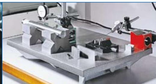
**Strumentazioni di misura per l'eccentricità**
