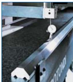
**Strumentazione di misura per la rettilineità delle guide GU.**
