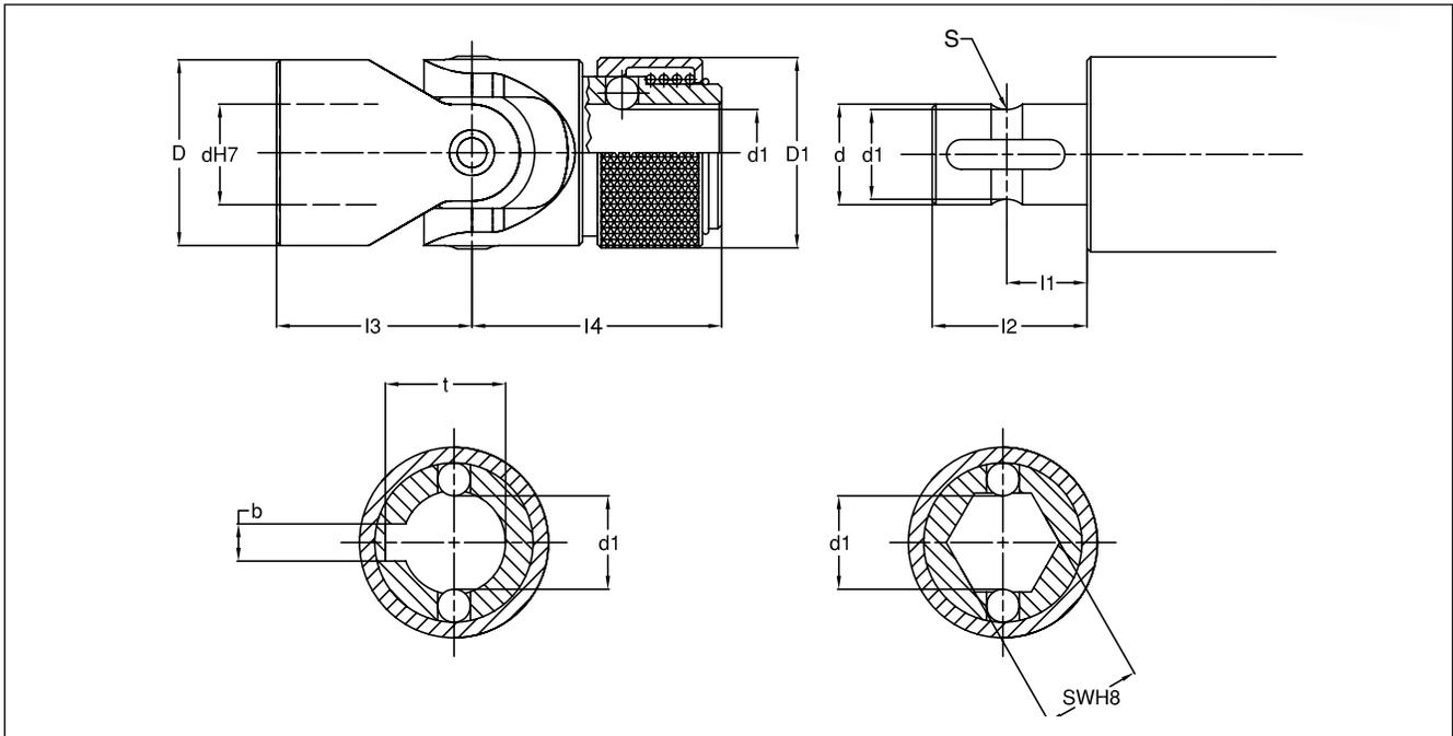
L'attacco rapido è costituito da una ghiera che impegna due sfere nell'apposita gola ricavata sull'albero. Sono disponibili per tutte le tipologie (LE, GE, WE) e per tutte le configurazioni (singolo, doppio, telescopico). Le coppie trasmissibili sono identiche a quelle dei giunti da cui derivano. Restano valide le medesime indicazioni per il montaggio e la manutenzione.
