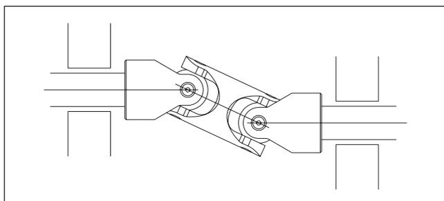
2. Per evitare fluttuazioni sinusoidali della velocità dell'albero condotto, è indispensabile fare in modo che l'angolo di entrata sia uguale a quello di uscita:
